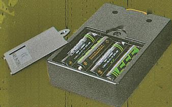
Открутите крепёжный винт задней крышки пульта управления, откройте её. Установите 4 батарейки или аккумулятора размера AA соблюдая полярность, как показано на рисунке. Затем установите крышку отсека и закрутите крепёжный винт. Разверните пульт к себе и включите питание, начнёт светиться соответствующий индикатор.
